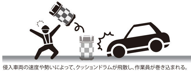
従来車両の速度や勢いによって、クッションドラムが飛散し、作業員が巻き込まれる。
