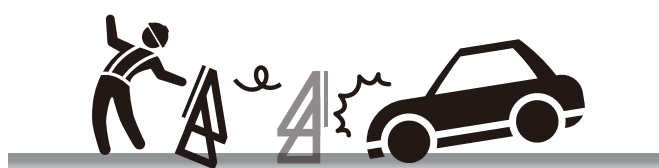
侵入車両の速度や侵入方向によって、バリケードが回転し作業員が巻き込まれる。
