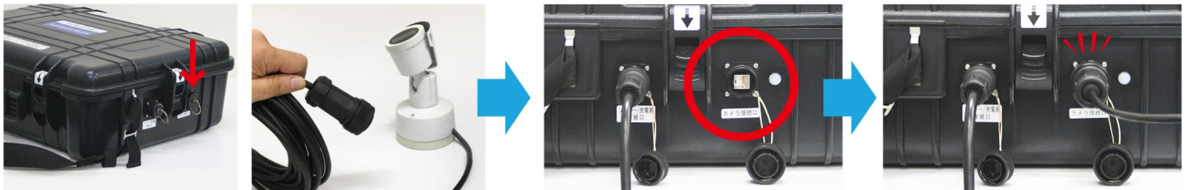
アタッシュケース型のバッテリーケース側面にWEBカメラの電源レセプターがありますのでキャップを反時計回りに回しながら引いて外し、WEBカメラのコネクターを接続してます。
